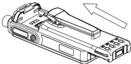
欲取下电池，请先将手持终端关机，然后将手持终端背面底部的门锁向上推，平行将电池往下推，取出电池。
