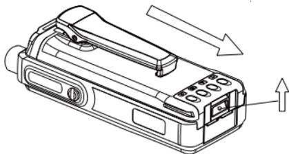
**注：请勿在手持终端处于开机状态下插、拔电池。**
